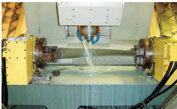
CNC401x2台完全同步运行 超长涡轮机叶片的加工
