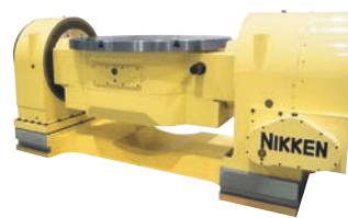
5AX-1200A: 倾斜中心 = 旋转轴转台中心
