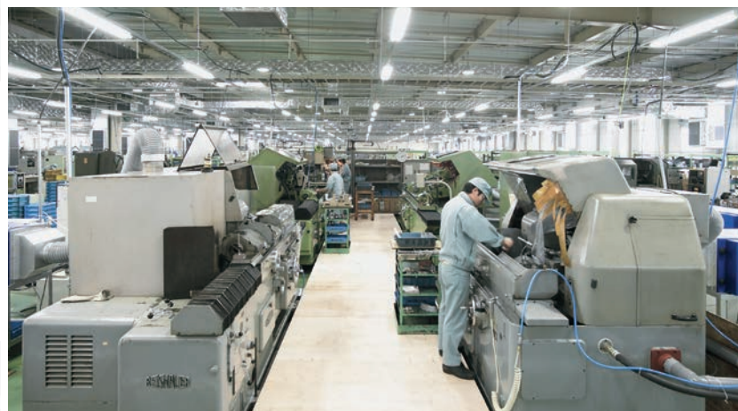
蜗轮蜗杆的齿合研磨生产线
