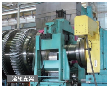
CNC1201仅用于 轴的分度。 汽轮机轴由带强 力夹紧机构的滚 轮支架支撑。
