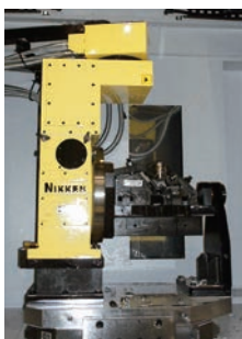
卧式加工中心B轴工作台的工件座上设置 CNC401T
