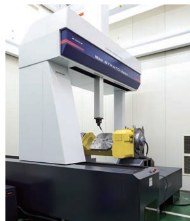
使用大型三维测量仪测量分度精度
