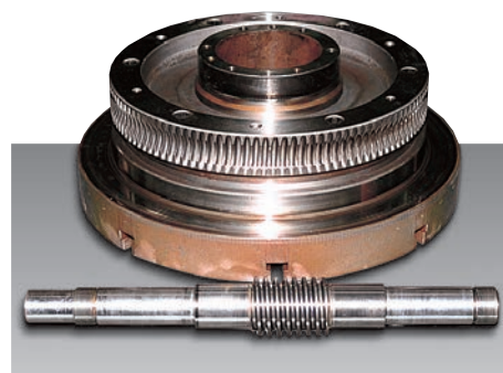
使用7年后的蜗轮蜗杆系统 极部磨损极少
