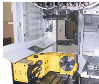
小型攻丝中心的交换工作台上安装2台CNC数控分度转台和转接箱
