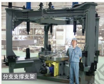
CNC1800& 分支支撑支架 大型圆盘的分度和夹紧
