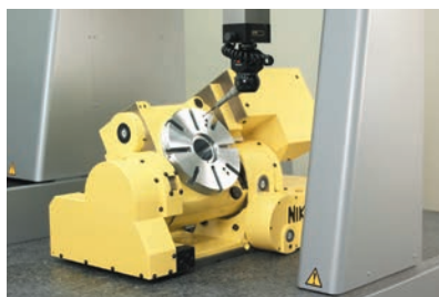
使用三维测量仪测量5AX-分度转台的精度
