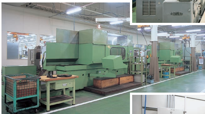
硬质合金蜗杆等的螺纹研磨生产线
